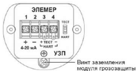
Рисунок 2.4 - Внешний вид коммутационной платы и функциональное расположение контактов для корпуса АГ-03, НГ-03 (АИР-20/М2-Н-ГС со встроенным модулем грозозащиты)
